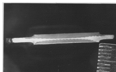
Рис. 14. Распределение деформаций при прокатке компрессорных лопаток (горизонтальное положение винта в поперечном сечении)
